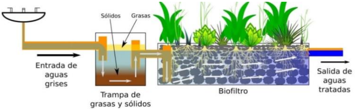
Esquema del funcionamiento de una biojardinería.
